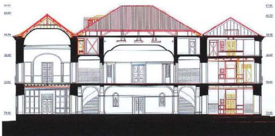
FIGURA 32 - 'Projeto de Requalificação e Conservação do Edifício do Palácio Galveias'. Alterações (amarelos e encarnados). Corte pelo átrio de entrada. Escritório JLLA, 2013 [Andrade, 2020, Anexo 17].
