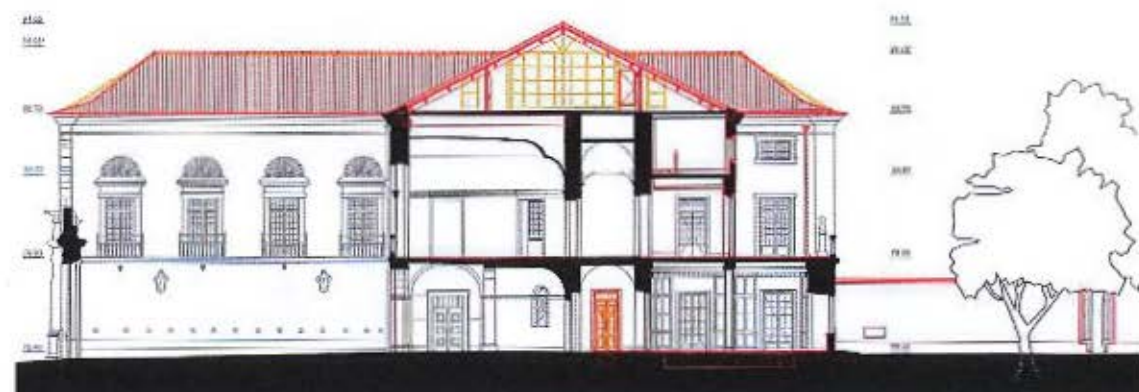
FIGURA 36 - 'Projeto de Requalificação e Conservação do Edifício do Palácio Galveias'. Alterações (amarelos e encarnados). Corte longitudinal pelo corpo central. Escritório JLLA, 2013 [Andrade, 2020, Anexo 17].
