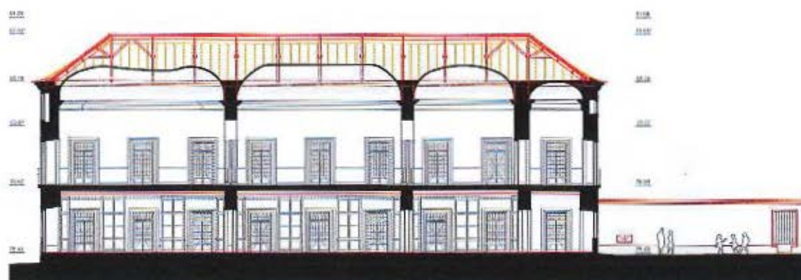
FIGURA 35 - 'Projeto de Requalificação e Conservação do Edifício do Palácio Galveias'. Alterações (amarelos e encarnados). Corte longitudinal pela ala nascente. Escritório JLLA, 2013 [Andrade, 2020, Anexo 17].
