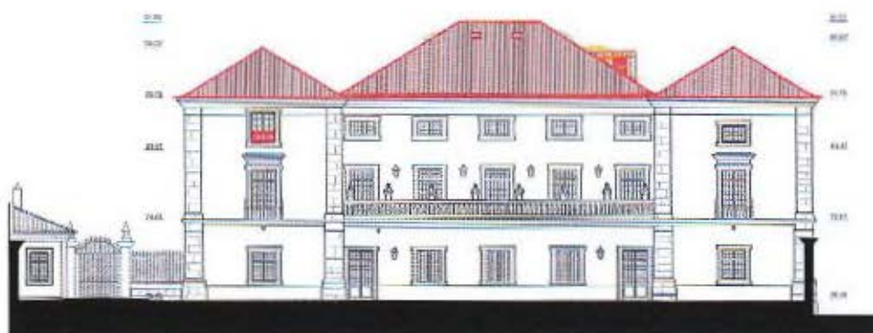
FIGURA 38 - 'Projeto de Requalificação e Conservação do Edifício do Palácio Galveias'. Alterações (amarelos e encarnados). Alçado Sul (tardoz). Escritório JLLA, 2013 [Andrade, 2020, Anexo 17].
