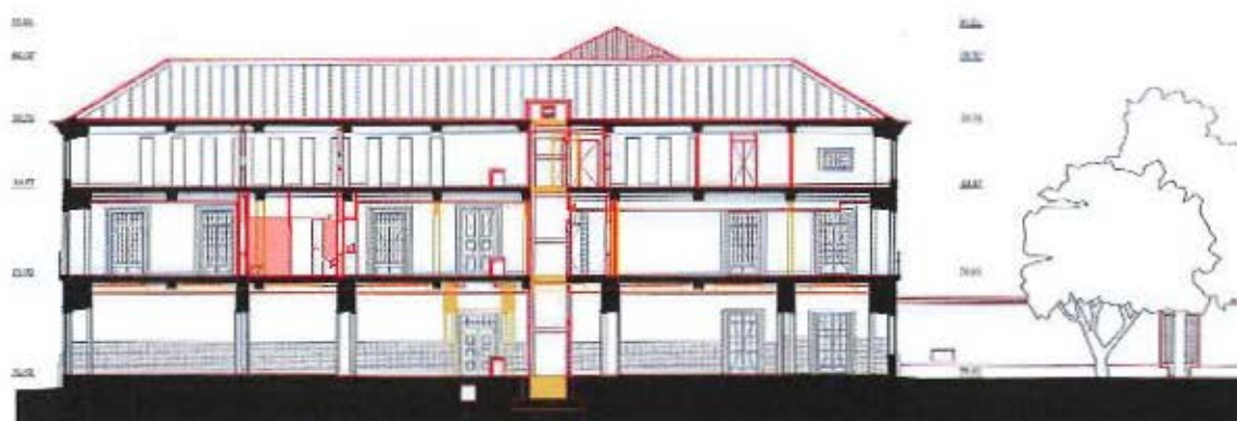
FIGURA 37 - 'Projeto de Requalificação e Conservação do Edifício do Palácio Galveias'. Alterações (amarelos e encarnados). Corte longitudinais pela ala poente. Escritório JLLA, 2013 [Andrade, 2020, Anexo 17].
