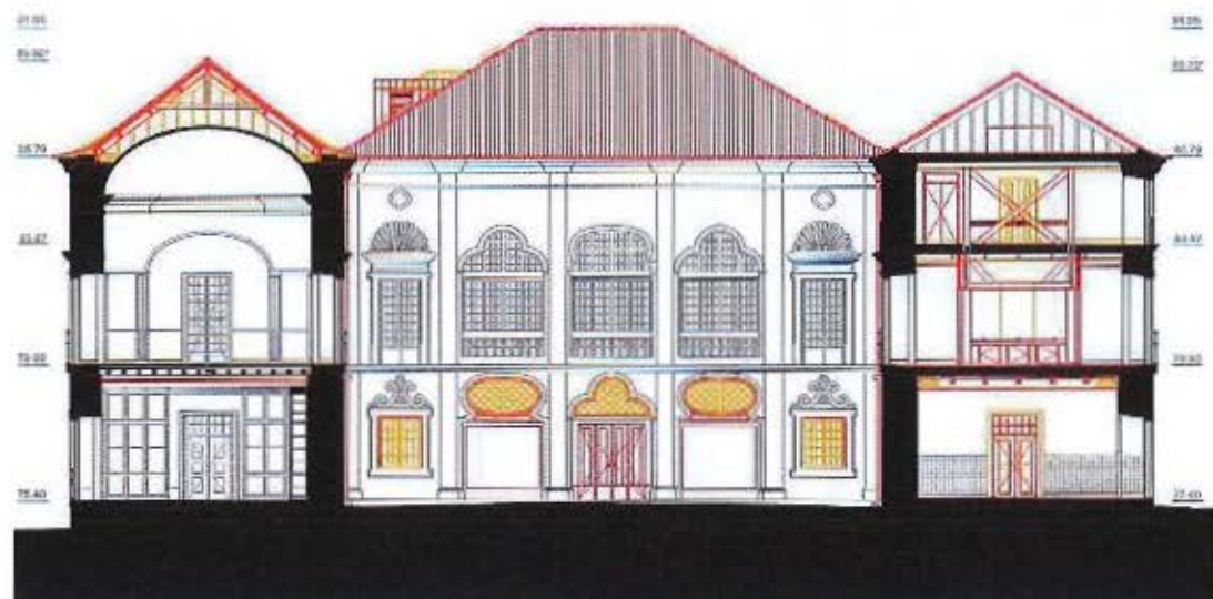
FIGURA 31 - 'Projeto de Requalificação e Conservação do Edifício do Palácio Galveias'. Alterações (amarelos e encarnados). Corte transversal pelo pátio. Escritório JLLA, 2013 [Andrade, 2020, Anexo 17].
