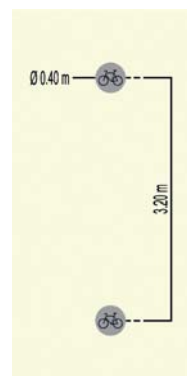
DISCOS EM PEDRA OU PRÉ MOLDADO DE BETÃO COM PICTOGRAMA DE BICICLETA. A APLICAR EM PAVIMENTOS EM CUBO (Ø 400 X 80 MM ESP.). COR NATURAL
