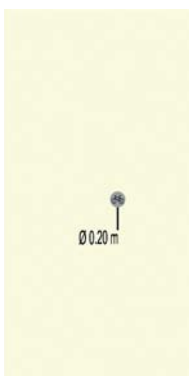
DISCOS EM CHAPA INOX COM PICTOGRAMA DE BICICLETA. A APLICAR EM PAVIMENTOS EM CALÇADA (Ø 200 MM). COR NATURAL
