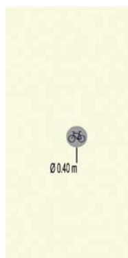
DISCOS EM PEDRA OU PRÉ MOLDADO DE BETÃO COM PICTOGRAMA DE BICICLETA. A APLICAR EM PAVIMENTOS EM CUBO (Ø 400 X 80 MM ESP.). COR NATURAL
