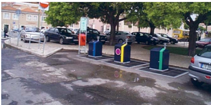
MODELO SUBTAINER DE 3,0 M3 DE CAPACIDADE, COM SISTEMA DE REMOÇÃO "KINSHOFER" - PARA OS MÓDULOS DE PAPEL, EMBALAGENS E VIDRO
