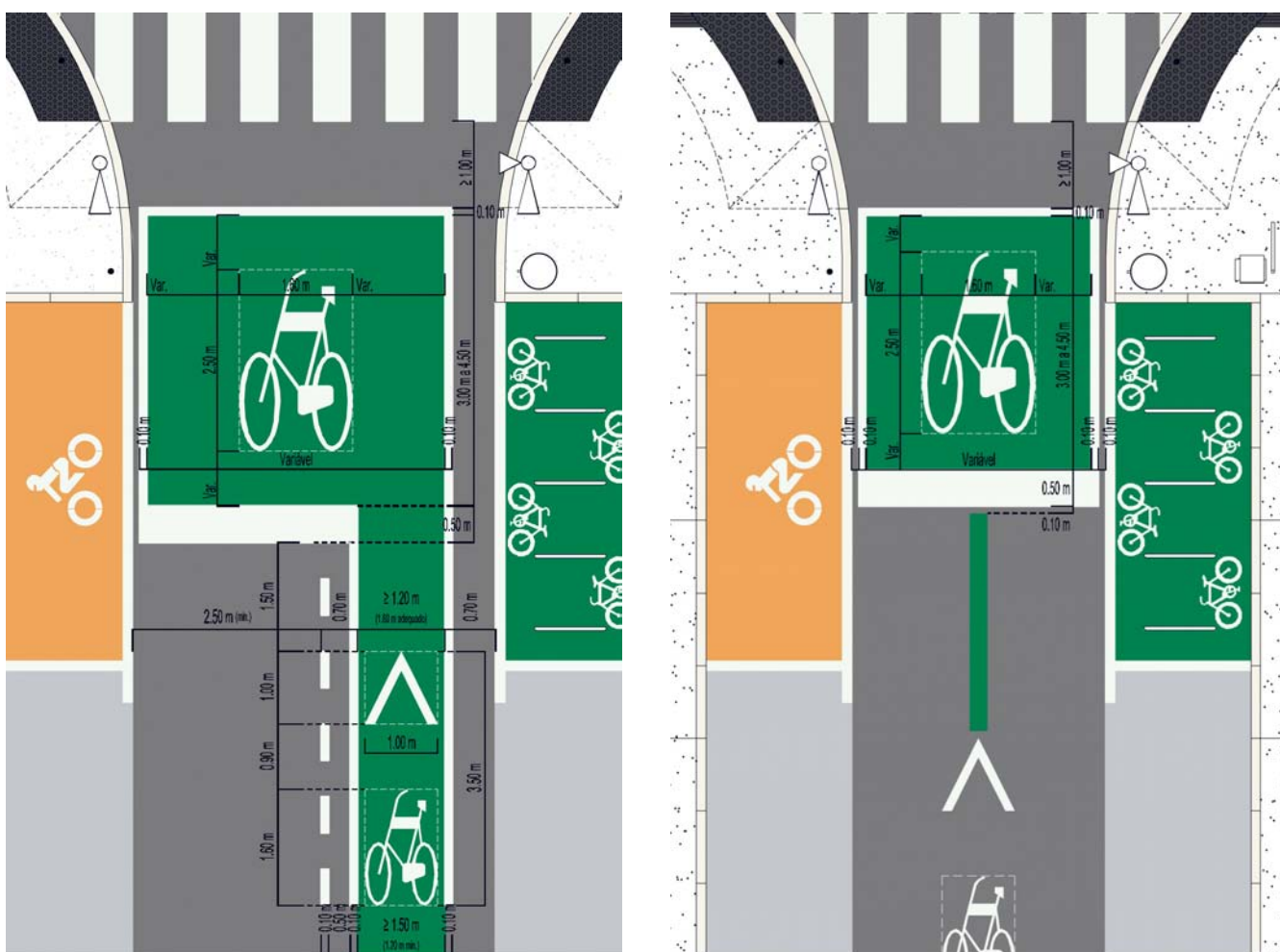
ZONAS AVANÇADAS PARA BICICLETAS - DIMENSÕES E IMPLANTAÇÃO
