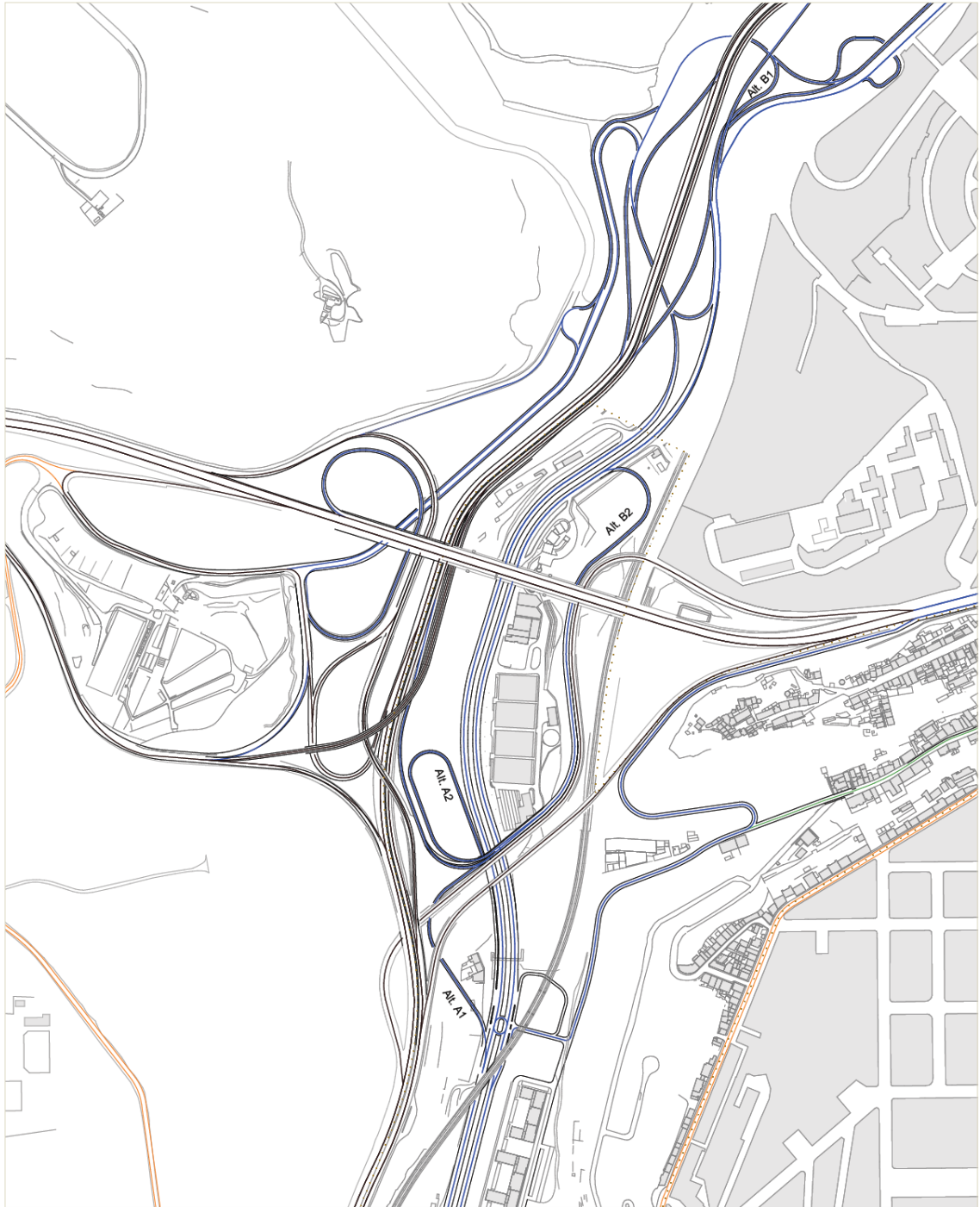
DESENHO 2 – Alternativas propostas para o Nó entre a Av. de Ceuta, o Eixo Norte-Sul e a A5
