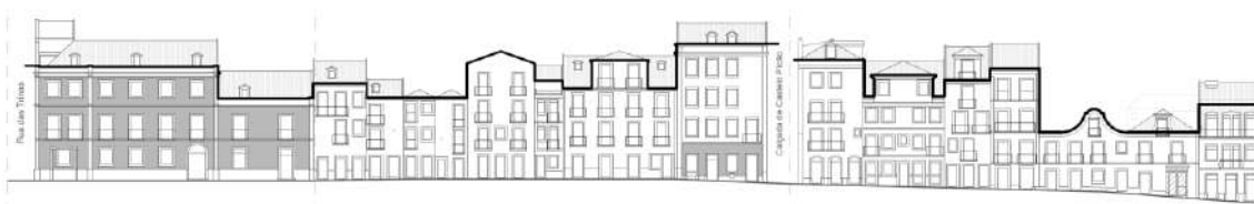
FIGURA 2 – ALÇADO DE CONJUNTO DE UM ARRUAMENTO E PROPOSTA DE REMATE DE CÉRCEA
