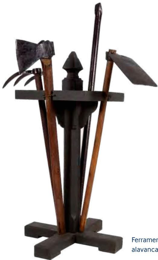
Ferramentas de socorro: Machado; enxada de bicos; alavanca e enxada © Júlio Barreiros
